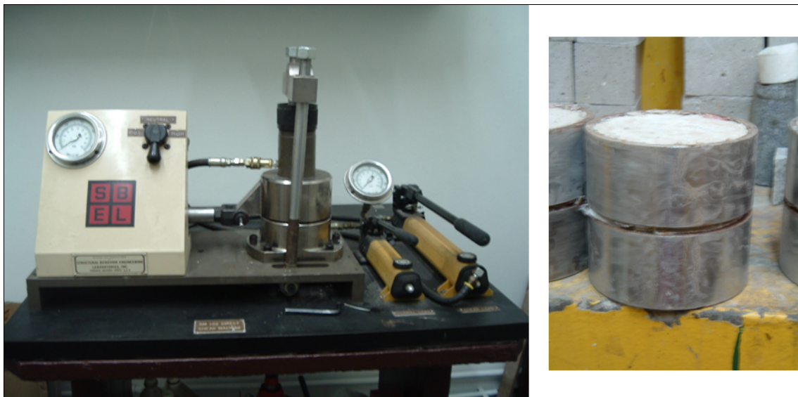
Figura 13 - Célula para ensaios de cisalhamento direto Fonte: Arquivo pessoal.
