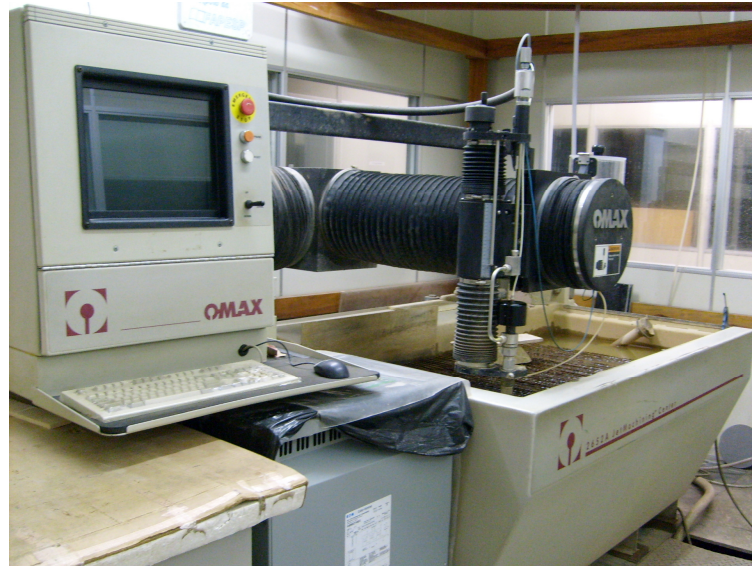
Figura 15 - Máquina para corte com jato de água de alta pressão Fonte: Arquivo pessoal.
